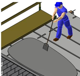
La table de compression éventuelle est toujours armée d'un treillis soudé de section minimum 150/150/5/5 ou de fibres dont le dosage et la spécificité sont à déterminer par le bureau d'étude en charge de la stabilité du bâtiment.
